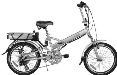
De elektrische vouwfiets heeft voor het leveren van trapondersteuning een 36 V accupakket met drie accu's in serie.
